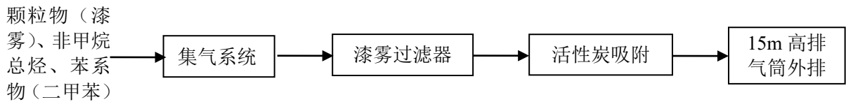
图 3-2 喷漆、烘干工序产生的废气处理流程示意图
