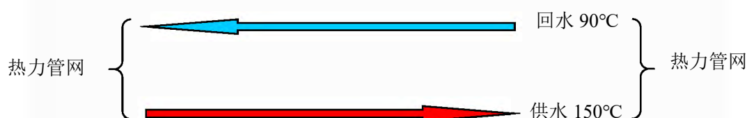
图 4 本项目热力管线运行简易流程示意图
