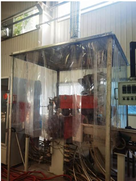
挤包绝缘层挤出机-集气罩和软帘
