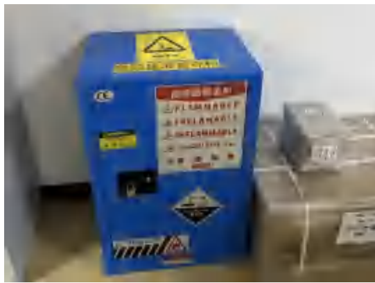
质检中心一层危险废液暂存柜
