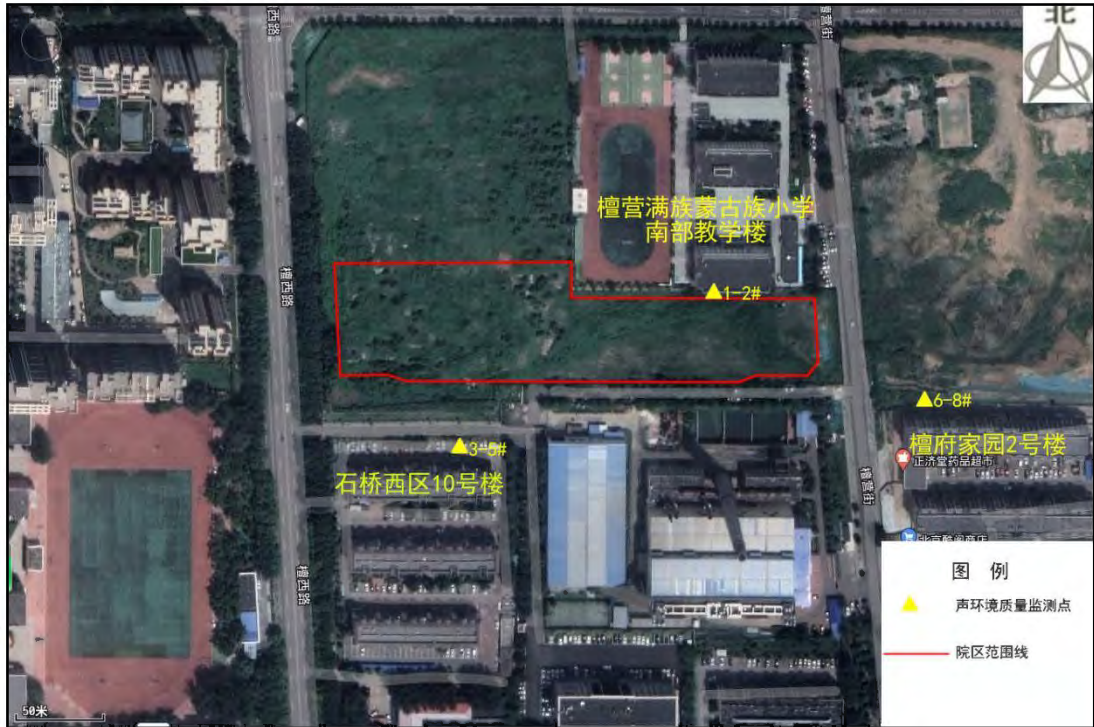
图 13 项目厂界外 50m 范围声环境保护目标处声环境质量监测点位图
