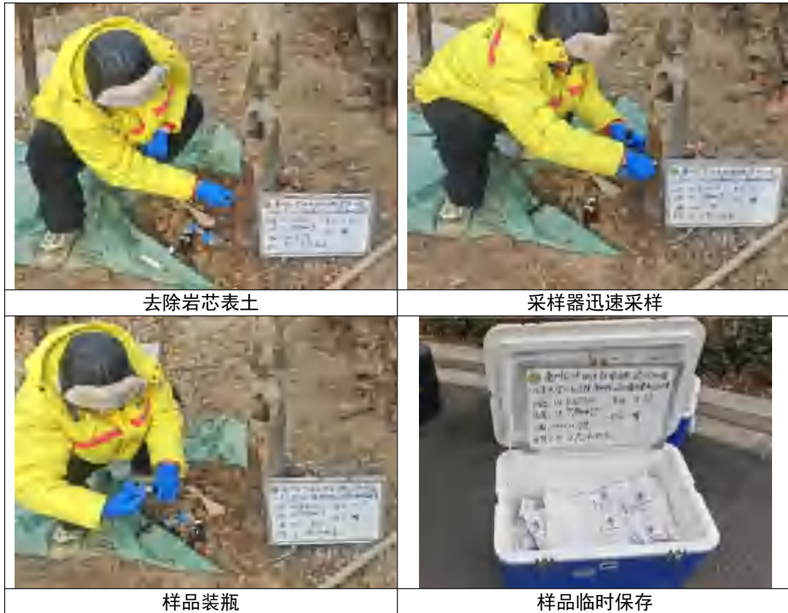
图 4.1-2 土壤 VOCs 采集过程
