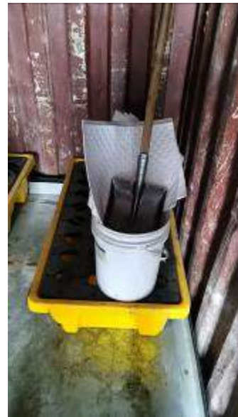
危废间内消防沙及吸附棉等应急物资
