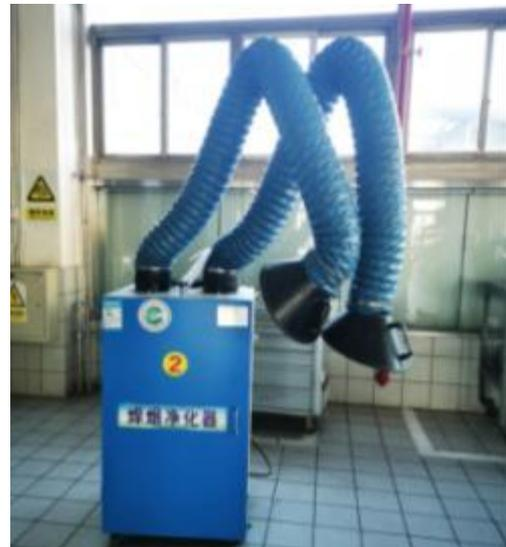
焊接工序移动式焊接烟尘净化器
